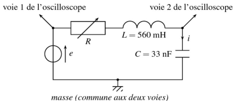
A l'instant  $t=0$ , la tension à vide  $e(t)$  passe brutalement de la valeur nulle à une tension positive (ici  $600 \text{ mV}$ ). On observe alors la réponse indicielle du circuit aux bornes du condensateur.
